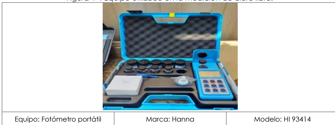
Figura 4-4 Equipo utilizado en la medición de cloro libre.
